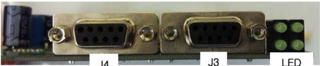
J4 : Modbus (D-sub 9Pin), J3 : BPS37 setup (D-sub 9Pin)
